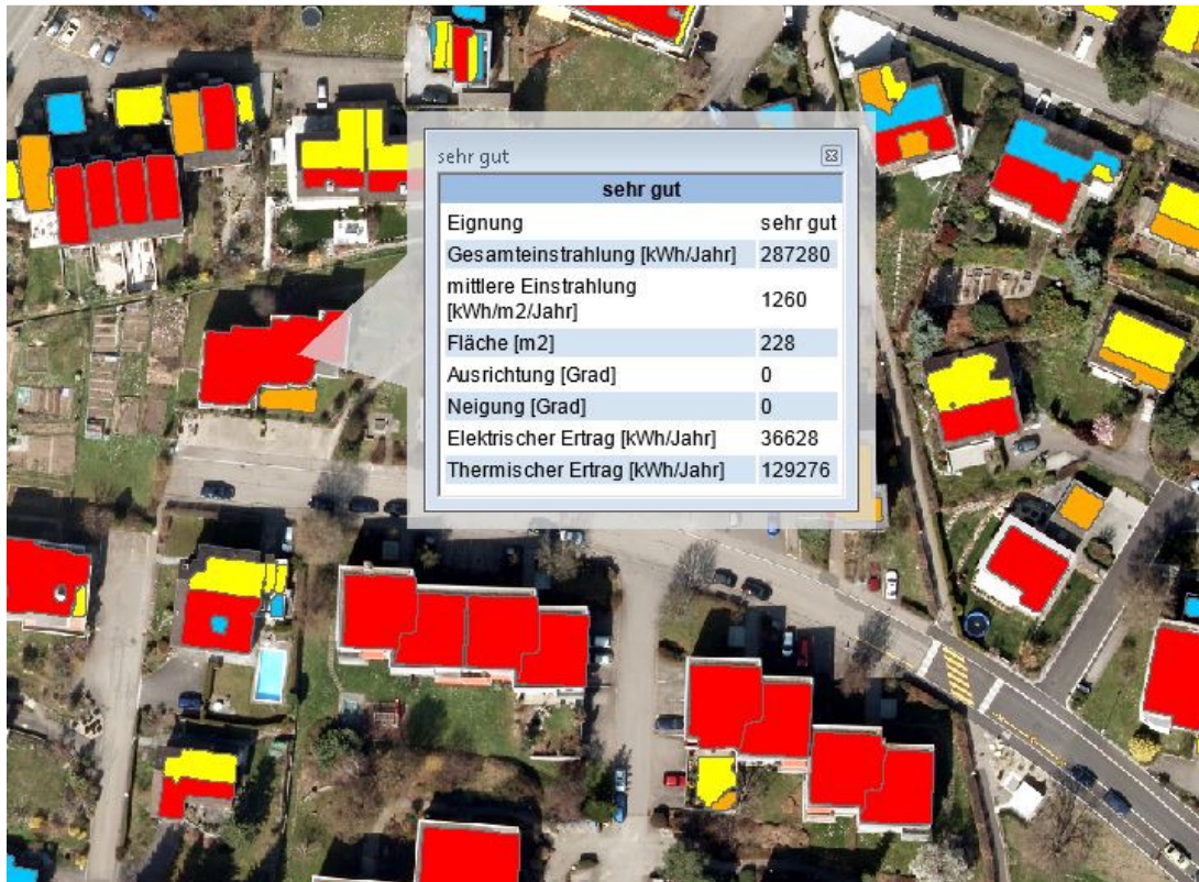
Abbildung 8: Solarkataster für das Beispielgebiet Tödistrasse mit den Eignungsklassen: Sehr gut, gut, mässig und schlecht (Orthophoto vom Bildflug im Frühjahr 2012).
